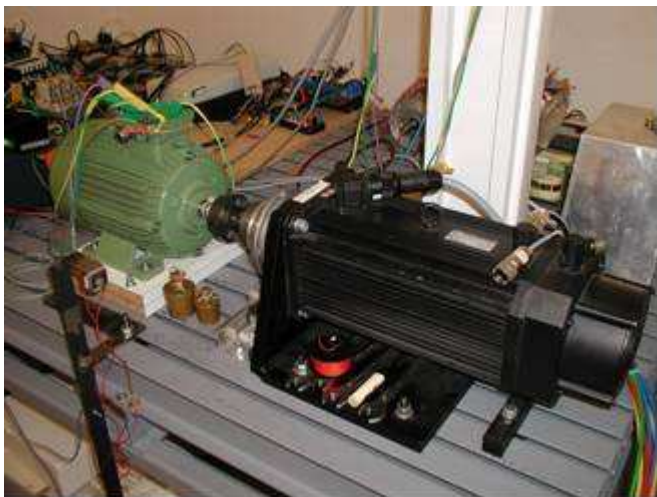
Abbildung 28: Antriebs- und Lastmaschine am Maschinenprüfstand
