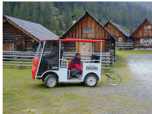
Abbildung 4: Messung von Geschwindigkeit und Weg mit „Peissler-Rad“
