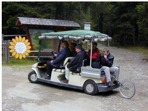
Abbildung 4: Messung von Geschwindigkeit und Weg mit „Peissler-Rad“
