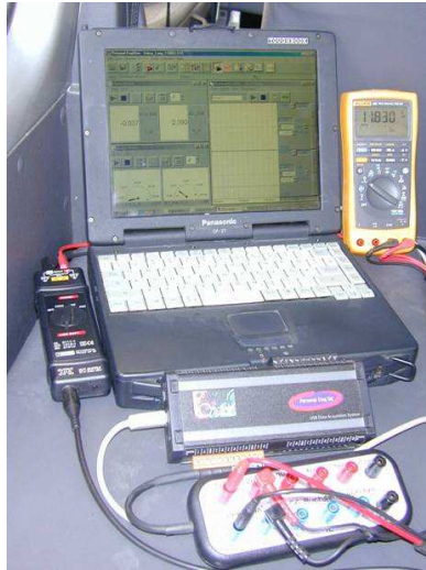
Abbildung 3: Messung von Motor-, Umrichter-, und Batterie-Kenngrößen während der Testfahrten
