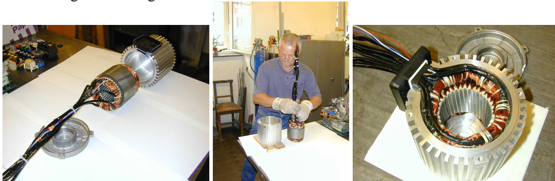
Abbildung 37: Einschrumpfen des Statorblechpakets in das Gehäuse
