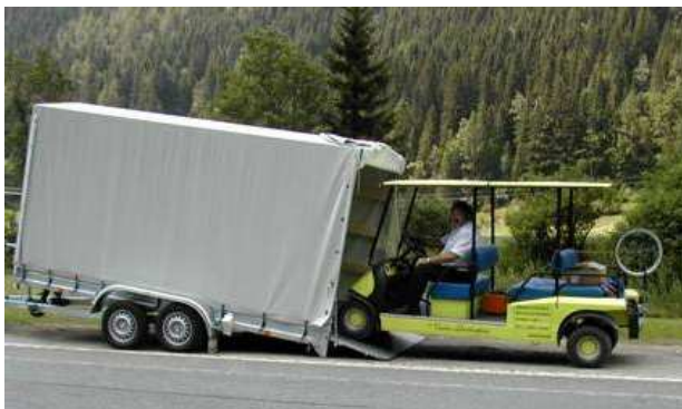
Abbildung 2: Spezialanhnger zum Transport der Elektrofahrzeuge zu den Einsatzorten
