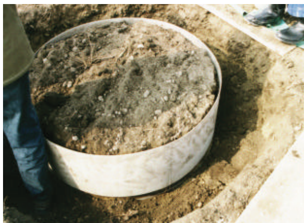
Abb. 8 Für die landwirtschaftliche Bodenbearbeitung muß der obere Stahlblechring des Lysimeters entfernt werden
