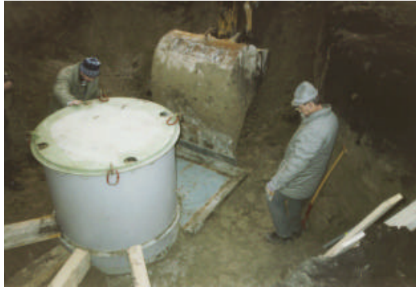
Abb.6 Die Schneidplatte trennt den Monolithen ab
