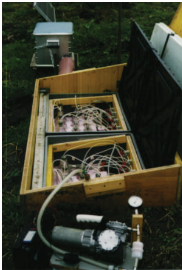
Abb. 4 Betriebsfertige Anlage mit solarbetriebener Vakuumeinheit 1999
