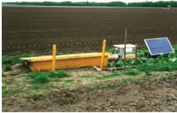
Abb. 9 Feldmeßstelle 2 (Karotte) mit der solarbetriebenen Vakuumeinheit im Hintergrund
