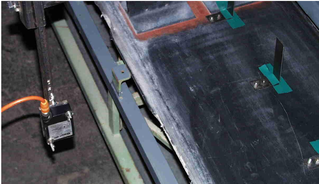
Abbildung 7: Lasersensor zur Messung des Abstandes von Pflanzenreihe
