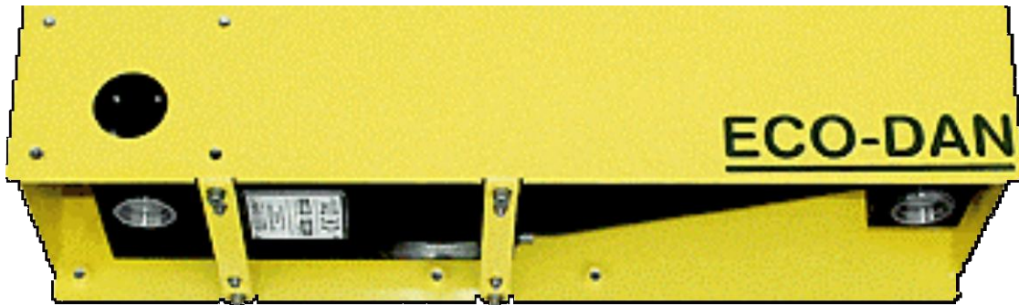
Abbildung 2: Doppelkamera mit integriertem Rechner
