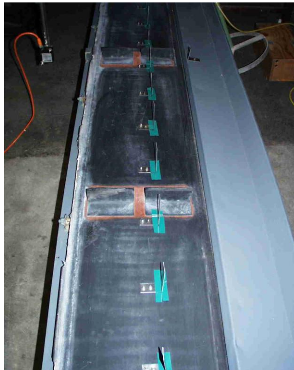
Abbildung 6: Förderband mit montierten Blechwinkeln und grünen Klebestreifen zur Simulation von Pflanzen
