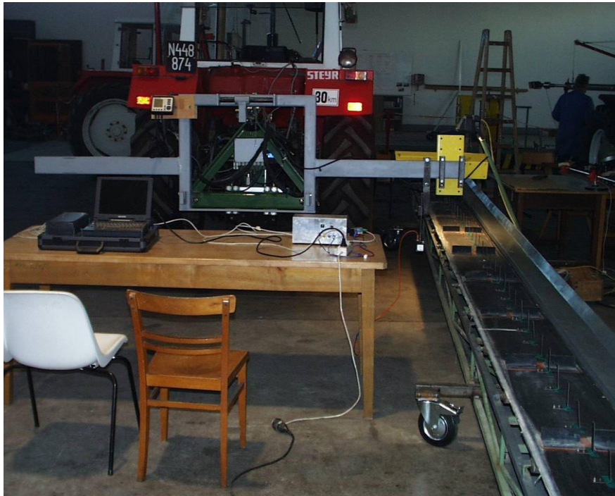
Abbildung 5: Versuchsanordnung zur Bestimmung der möglichen Fahrgeschwindigkeit
