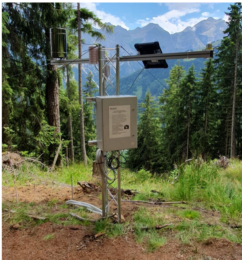
Abbildung 2: Foto eines Zentralen Masts aufgebaut im Rahmen eines Feldtests bei Mahderberg in Neustift.
