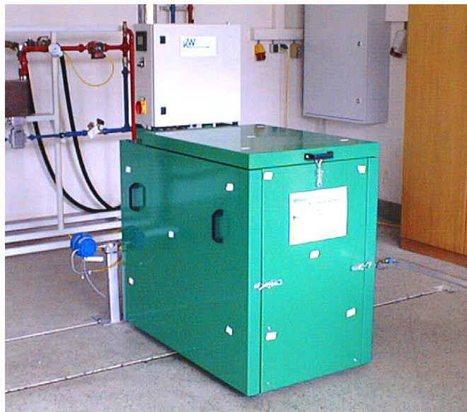
Bild 21: BHKW im Dauerlauf am Prüfstand
