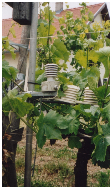
Abbildung 2-3: Vergleichsmessung mit der geeichten Referenzstation des Institutes für Meteorologie mit einer ADCON-Klimastation.
