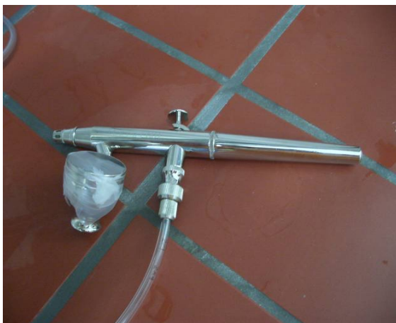
Abbildung 19: Airbrush–Pistole (HansaHobby Line 681) mit 0,3 mm Düse.
