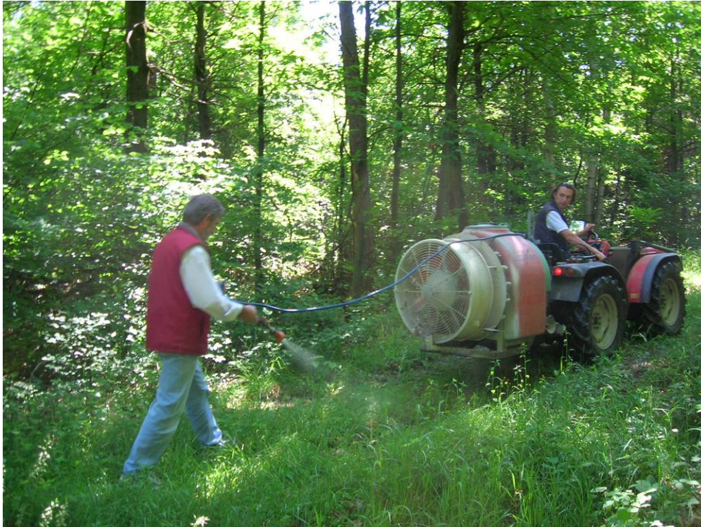
Abbildung 30: Sprühapplikation mittels Spritzpistole (Aufsattelspritzgerät Lochmann befestigt auf einem Schmalspurtraktor).
