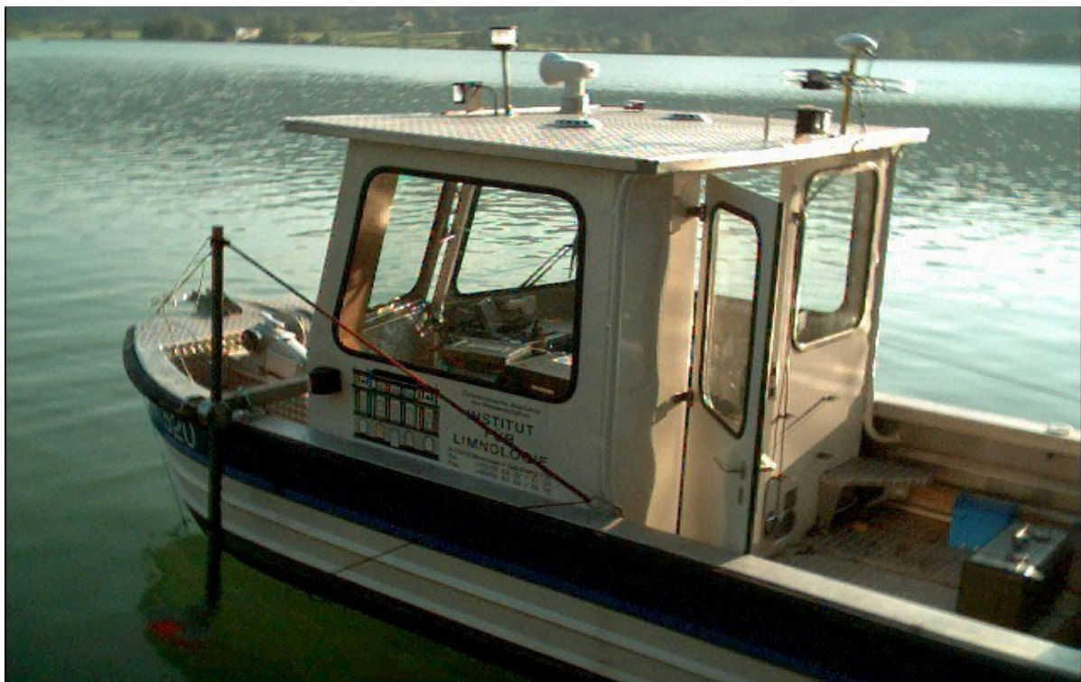
Abbildung 9.: Echolotboot mit montierten Transducer (Schallgeber und -empfänger)
