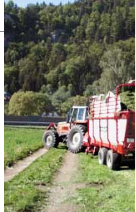
Aufgrund der ungünstigen Feldstückformen, des nicht zusammengespielten Ernteteams (Transport-Häckslerfahrer) und der geringen Schwadgewichte lag die Flächenleistung weit unter den Erwartungen von 2,5 bis 3,0 ha/h.
