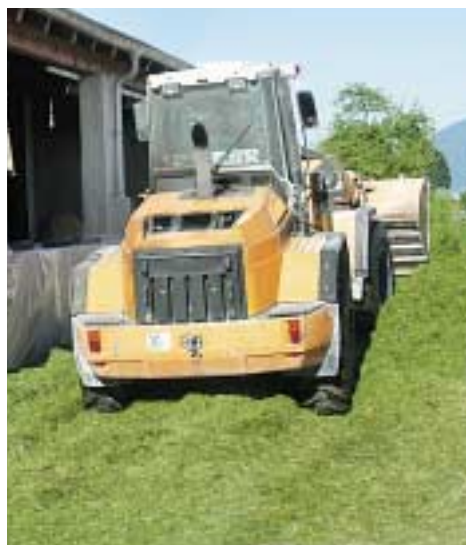
Die Erntemengen von 4000 bis 7000 kg TM/ha und Stunde sind mit einem schweren Walztraktor verdichtbar.
