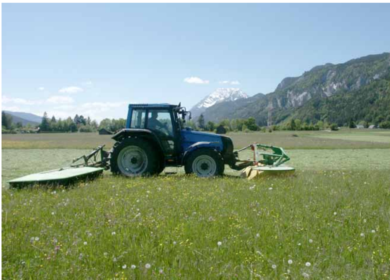
Die Mähkombination schaffte eine Arbeitsleistung von 3,5 ha/h bei 5,5 m Arbeitsbreite.
