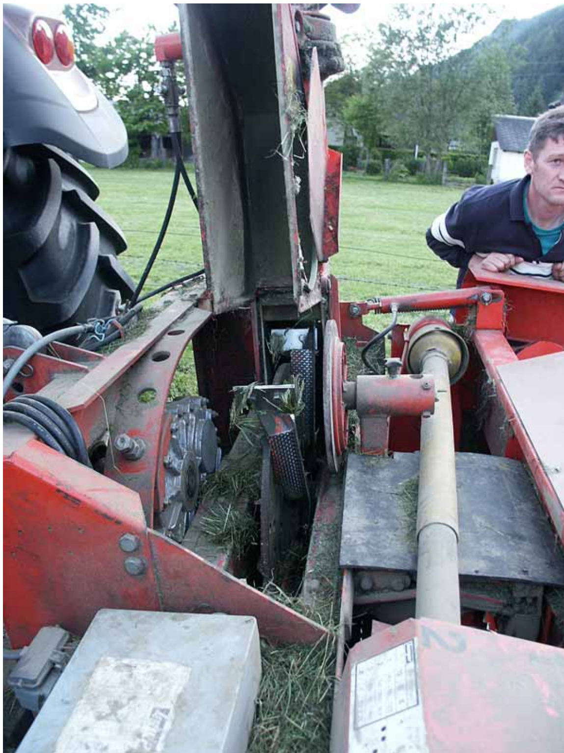
Das Messerschleifen ist einfach durchzuführen, erfolgte alle 3 bis 5 Stunden Häckselzeit und dauerte nur 10 bis 13 Minuten.
