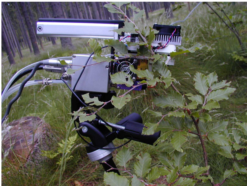
Foto 2 Messkammer des LI-COR 6400 an Buche
