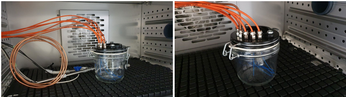
Abbildung 34: Das Multiplexing-Messsystem während der Datenaufzeichnung zur Ermittlung von Kalibrationsdaten vor (links) und nach (rechts) dem Einbau aller Komponenten in das 19-Zoll Flight-Case.
