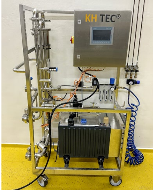
Links ein Gerät zum CO 2 - bzw. Gas-Management, rechts das Herzstück der Anlage, eine hydrophobe Membran. Mit dieser kann auch Alkohol entfernt werden.
