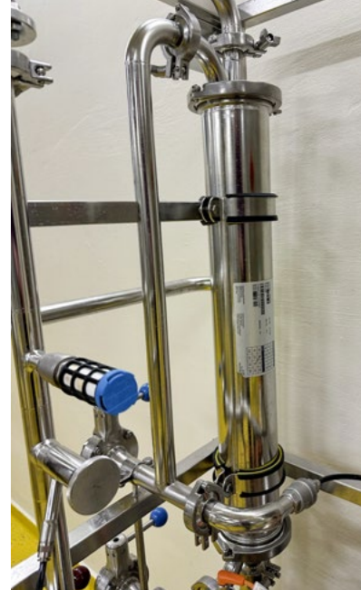
Links ein Gerät zum CO 2 - bzw. Gas-Management, rechts das Herzstück der Anlage, eine hydrophobe Membran. Mit dieser kann auch Alkohol entfernt werden.
