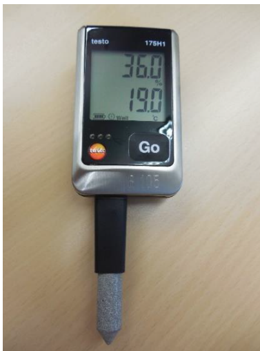
Abbildung 5 Datalogger „Testo 175H1“ zur Aufzeichnung von Temperatur und Luftfeuchtigkeit in den Abteilen
