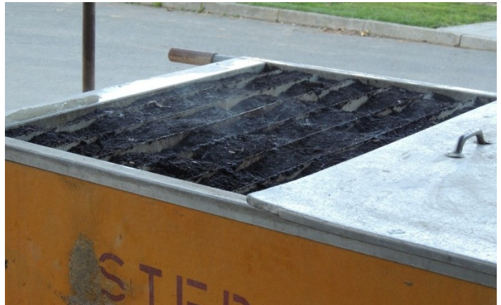
Abbildung 17: Der Bodendämpfer Sterilo 7K. Nach 5-stündigem Dämpfen des kompostierten Pilzsubstrats bei 90°C geöffnet.
