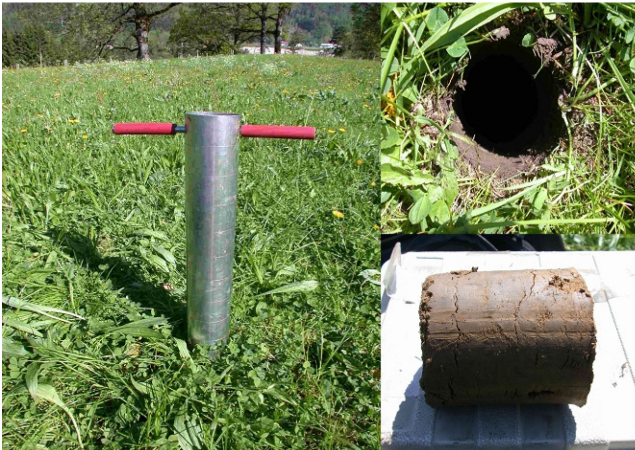
Abb. 10: Links: Rohr (Durchmesser: 8 cm) zur Entnahme der Bodenproben zu Versuchsbeginn 2004 und zu Versuchsende 2006; rechts oben: Probennahmestelle nach der Probenentnahme; rechts unten: Ausgestochener Bodenzylinder (Durchmesser 8 cm, Länge 10 cm).
