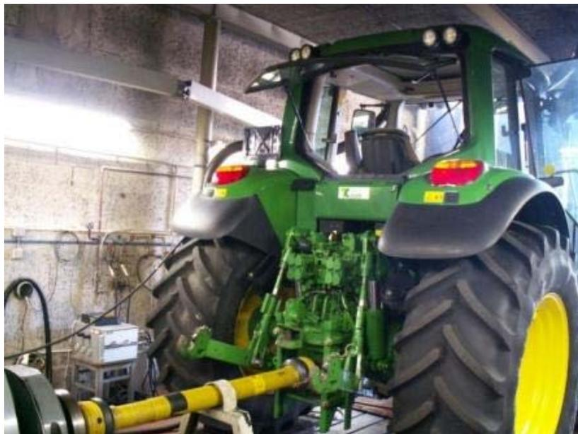
Abbildung 48: Leistungsmessung an der Zapfwelle am Motorprüfstand von FJ-BLT
