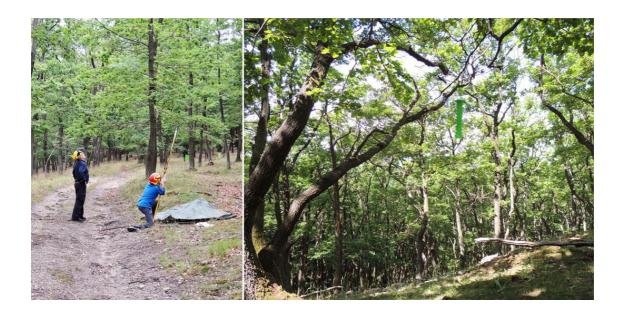
Abbildung 8: Installation einer Mehrtrichterfalle in einer Eichenkrone: Mit einer Schleuder wird das Seil über einen möglichst freien, ausreichend starken Ast geschossen. Dann wird die Falle in einem sonnenbeschienenen Teil der Krone positioniert. Das Seil wird um den Stamm gebunden, so dass die Falle bei der Kontrolle leicht gesenkt und wieder gehoben werden kann.
