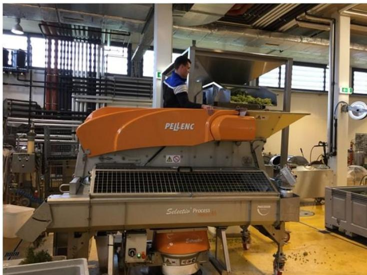
Abb. 3: Selectiv Process M mit angebautem Extractiv Crusher
