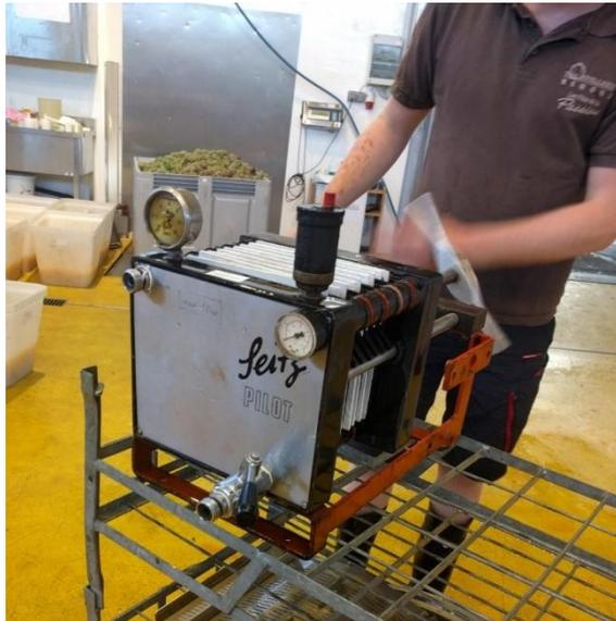
Abb. 17: Schichtenfilter
