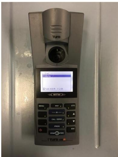
Abb. 18: NTU-Messgerät
