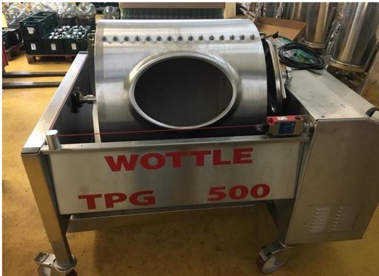
Abb. 2: Pneumatische Presse der Fa. Wottle
