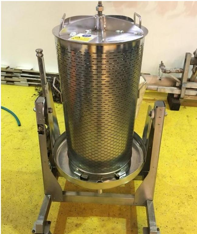
Abb. 5: Vertikale Pneumatische Presse
