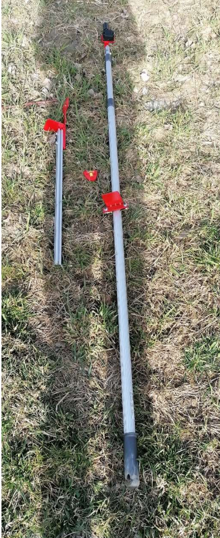
Abbildung 23: 0,8 Meter Messtab und 2 Meter Messtab mit kleiner Wasserwaage und Signalempfänger (eigene Aufnahme)
