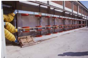
Abbildung 4: Rundballentrocknungsanlage mit doppelstöckiger Beschickungsmöglichkeit
