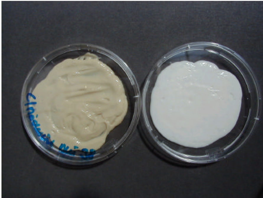
Abbildung 11 O/W Emulsion mit 3% Mädesüß Blüten Extrakt (links) im Vergleich zur unbehandelten Emulsion (rechts)
