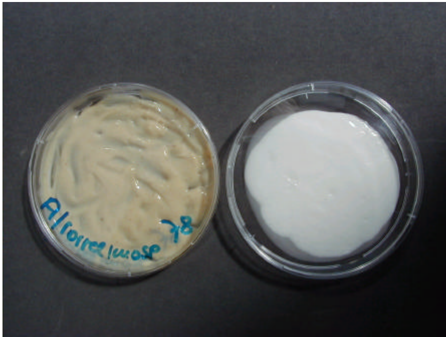
Abbildung 9 O/W Emulsion mit 3% Balsampappel Knospen Extrakt (links) im Vergleich zur unbehandelten Emulsion (rechts)
