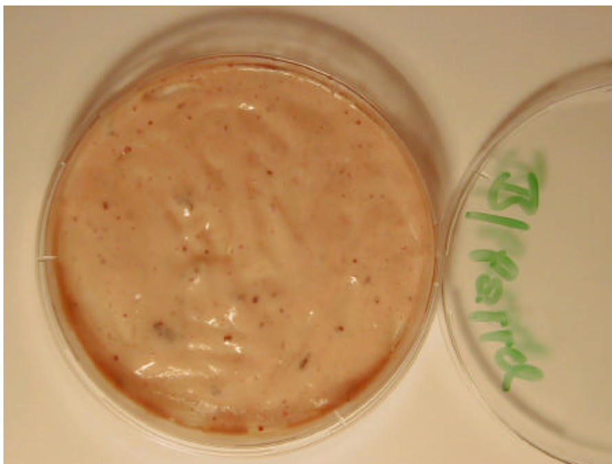
Abbildung 14 O/W Emulsion mit 3% Balsampappel Knospen Extrakt, beimpft mit 1.4 \times 10^6 CFU Aspergillus niger und Trichoderma viride , nach 4 Wochen Inkubation
