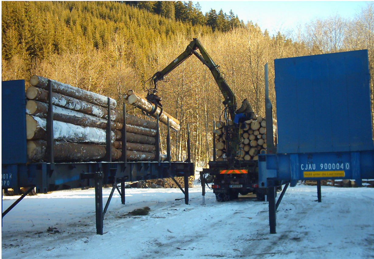
Abbildung 1: LogRac beim Beladen durch Rundholz-LKW
