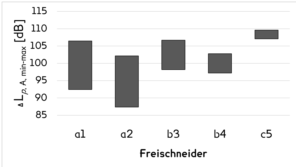
Abbildung 7: Differenz des mittleren minimale Schalldruckpegels und des mittleren maximalen Schalldruckpegels der Freischneider a1-c5.
