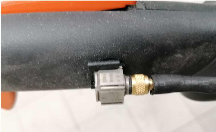
Abbildung 2: Befestigungsclip mit Beschleunigungssensors montiert am Handgriff eines Freischneiders.
