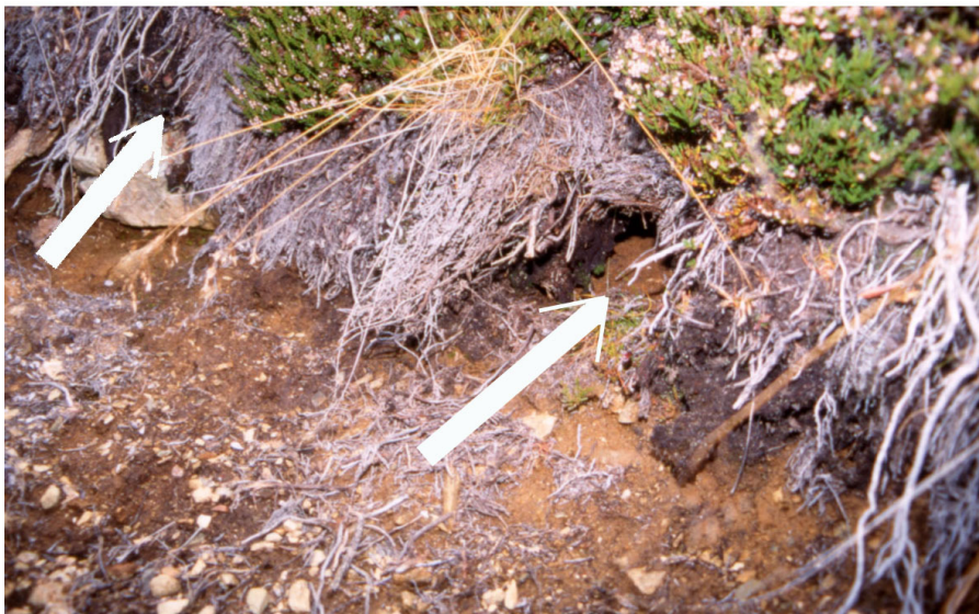
Abbildung 66: Bei genauerer Betrachtung der Anbruchskante fällt auf, dass unter der Vegetation bis zu 50 cm tiefe, hangparallele Löcher zu finden sind (s. Pfeile); es handelt sich hierbei nicht um Ausspülgelücken, sondern um Siphons, die Wasser von oberhalb des Walles (siehe Abbildung 65) bis hierher transportieren.
