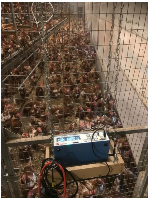
Abbildung 25: Montage der Staubmesstechnik im Nahebereich des Scharraumes
