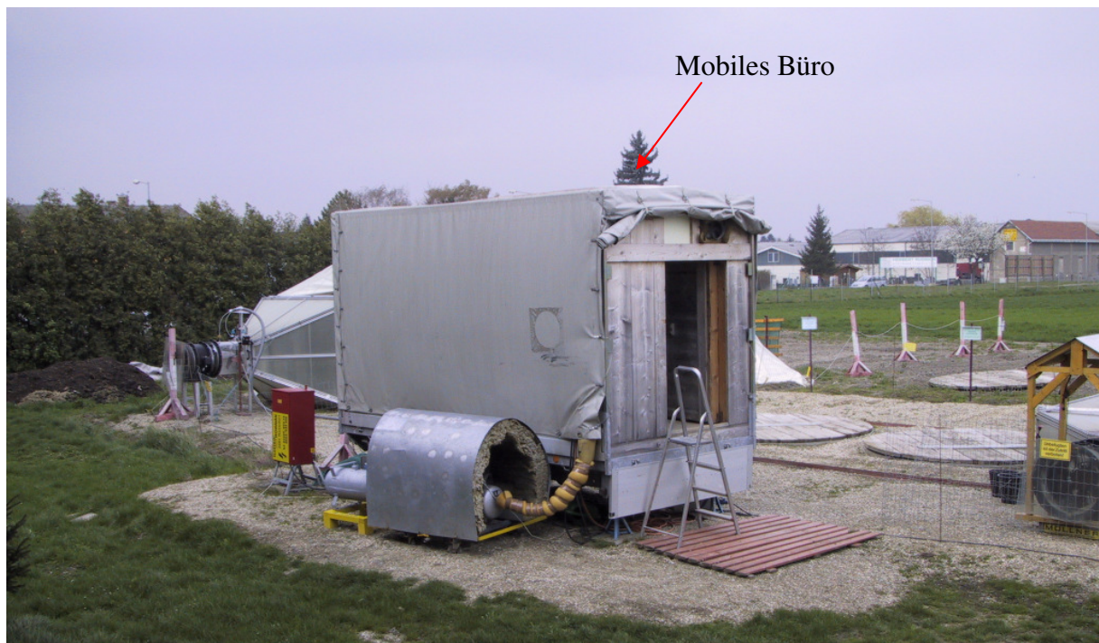
Anhang-Foto F.6. Versuchsanlage zur Messung von klima- und umweltrelevanten Gasen aus flüssigen und festen Wirtschaftsdüngern an der Versuchswirtschaft der Universität für Bodenkultur in Groß-Enzersdorf
