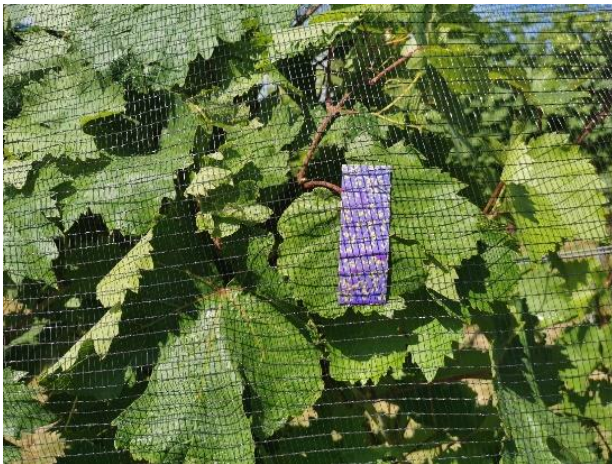
Abbildung 11: Water Sensitive Paper unter dem Hagelschutznetz nach der Applikation
