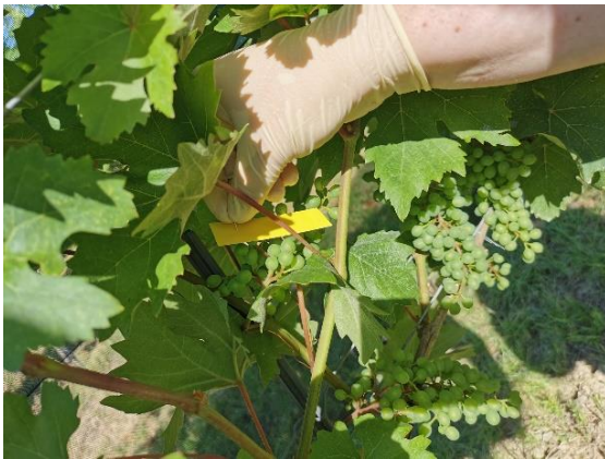
Abbildung 10: Anbringen der Water Sensitive Paper in der Traubenzone
