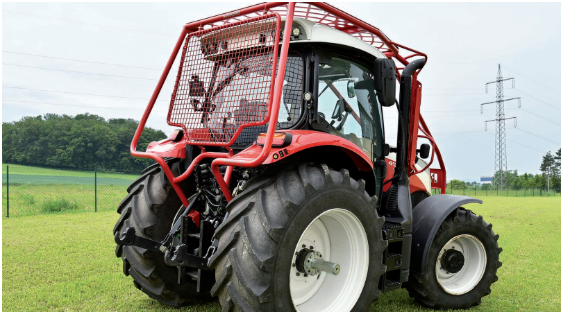
Ein genehmigter Forstaufbau mit FOPS und OPS bietet Schutz für den Bediener und bestimmte Traktorbauteile. Fotos: Fussel
