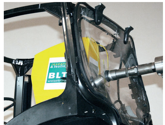
Am Prüfstand der BLT Wieselburg wird eine Kunststoffscheibe im Traktorheck einer OPS-Prüfung unterzogen.
