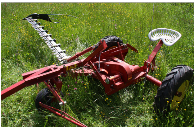
Abbildung 02: Ein Doppelmessermähwerk aus Amerika wurde bei den Mähversuchen verwendet.
