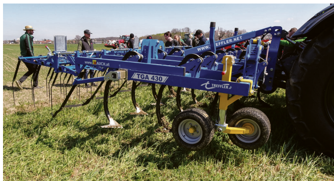
Sogenannte Exaktgrubber sind für die „ultraflache Bearbeitung“ mit Tiefenführungsradern und Gänsefußscharen ausgestattet. Bei angebauten Geräten kann dabei auf das Nachlaufgerät verzichtet werden bzw. mit Striegelwerkzeugen ersetzt werden.
