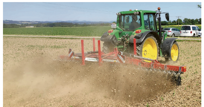
Die Sternrollhacke ist besonders bei leicht verkrusteten Böden für eine Beikrautkontrolle im Vor- und Nachaufbau geeignet. Die hohe Flächenleistung ermöglicht auch den überbetrieblichen Einsatz
