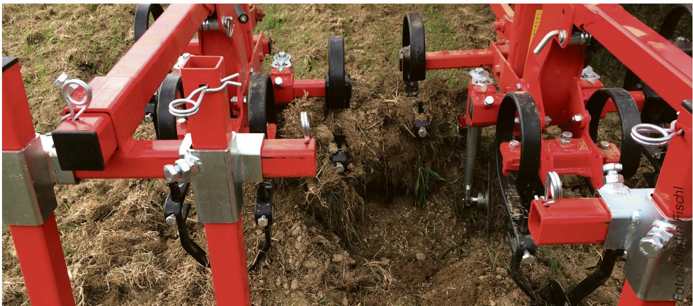
Kommt es zu Verstopfungen im Zwischenreihenbereich, können beim ersten Hackdurchgang die Schare hochgestellt werden. Beim zweiten Hackdurchgang ist die Verstopfungsgefahr meist schon weit geringer.
