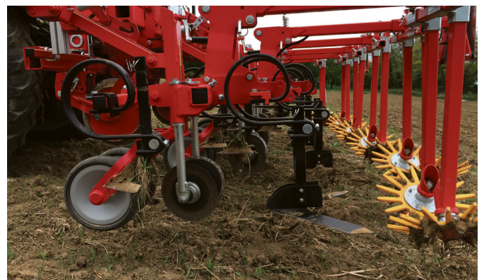
Die Ausstattung mit Räumscheiben vor den Winkelscharen reduziert die Gefahr des Verstopfens. Im Zwischenreihenbereich sind wenige, breite Schare angeordnet, um möglichst hohen Durchgang zu gewährleisten. Foto: Martin Fischl
