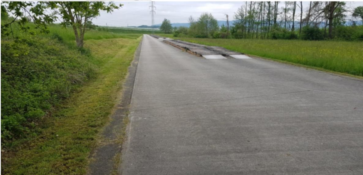
*Abbildung 43: 100-m-Testbahn mit 5 cm Abstand zwischen den Holzbalken*
