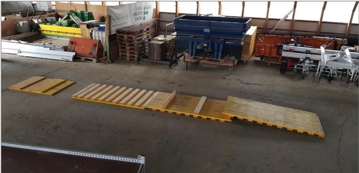
Abbildung 38: Künstlich angelegte Bahn mit definierten Unebenheiten
