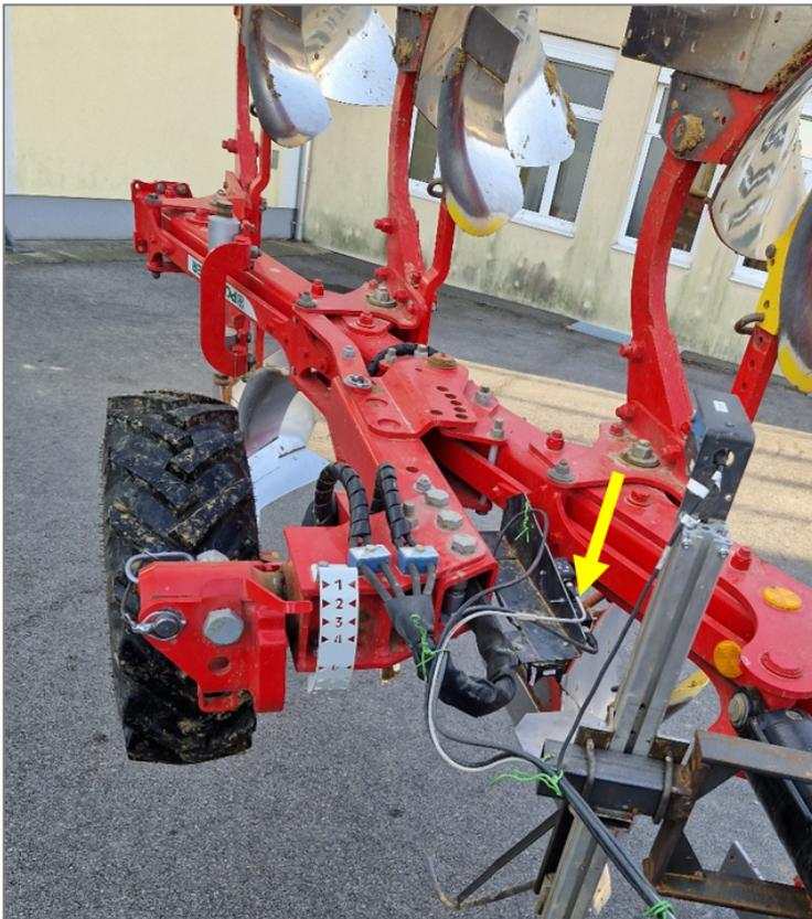
Abbildung 92: „Radar1\_Bodenoberfläche“ und „Laser\_direkt am Boden1500“ (Baumer) neben dem Stützrad montiert
