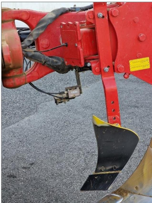
Abbildung 90: „Radar2\_Bodenoberfläche“ und „Laser\_direkt am Boden600“ (Baumer) am Pflug vorne montiert
