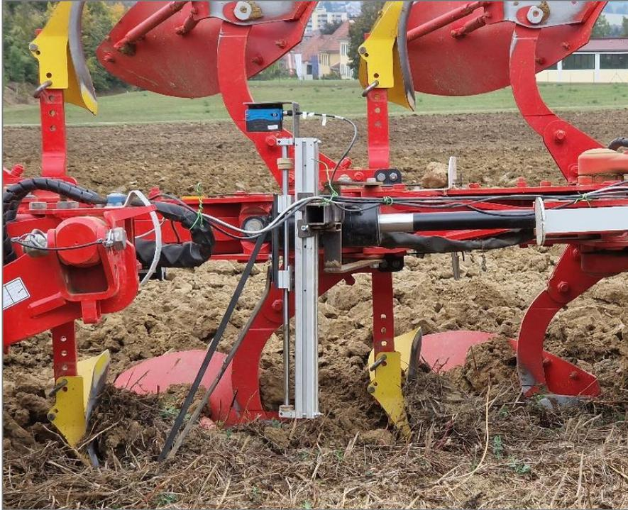
Abbildung 91: „Taster\_Linearführung“ in der Pflugmitte montiert
