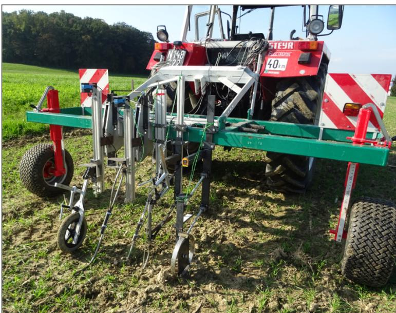
Abbildung 15: Sensoren auf dem Trägerrahmen montiert
