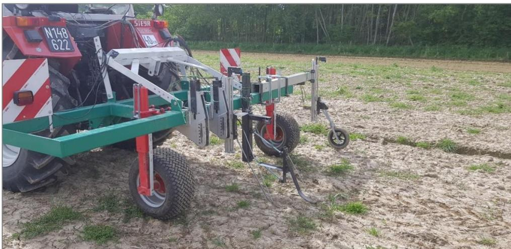
*Abbildung 1: Messrahmen zur Befestigung der Tiefenmesseinrichtungen*
