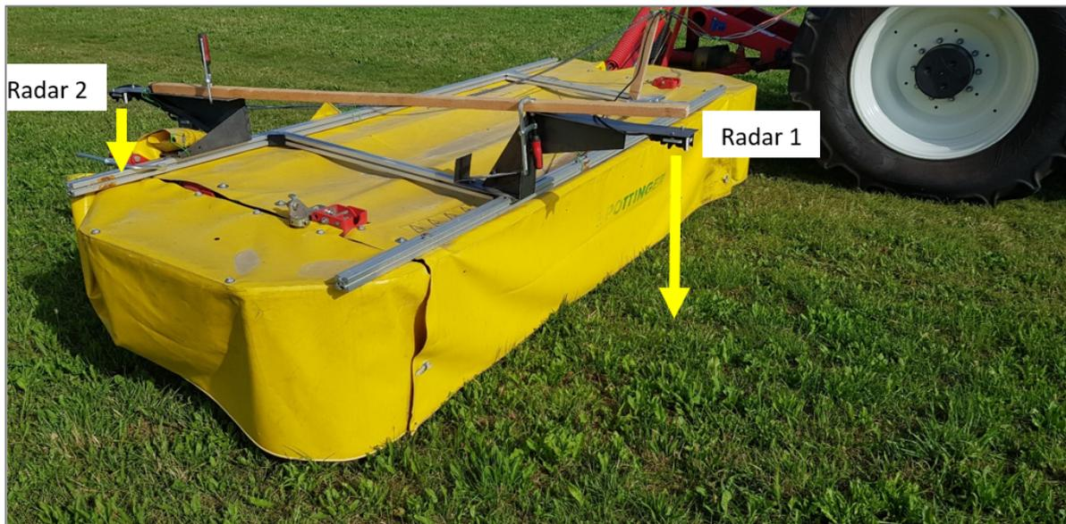
*Abbildung 76: Radarsensoren vorne und hinten am Mähwerk befestigt*
