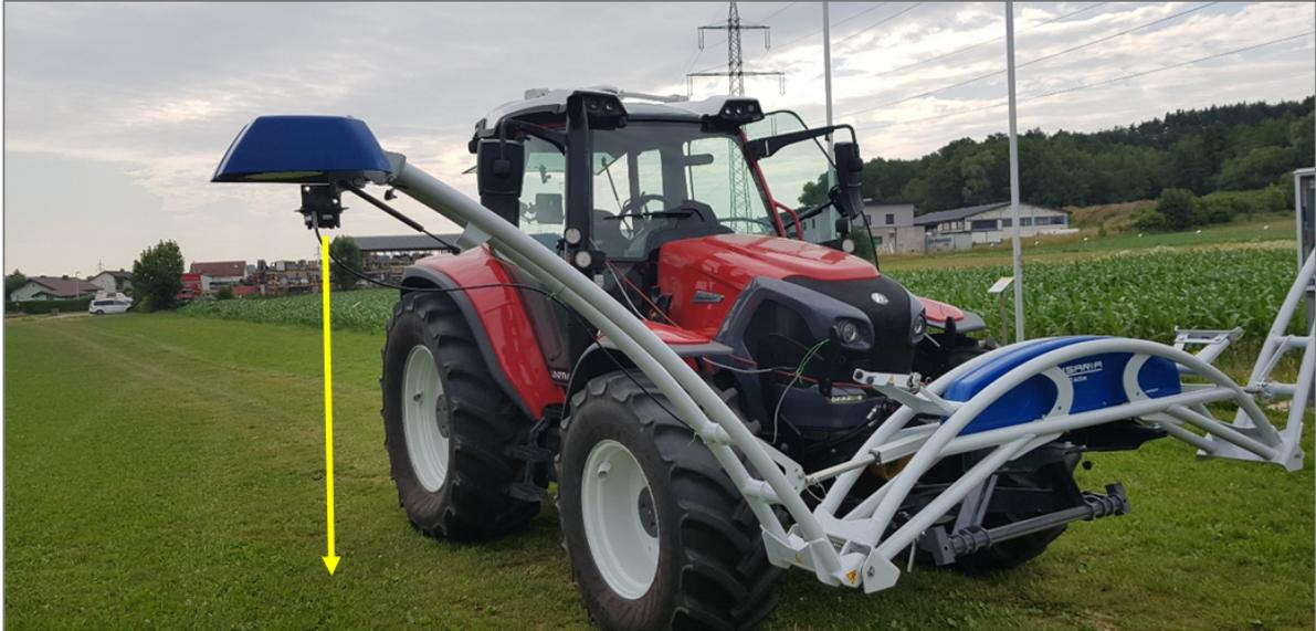
Abbildung 84: Radarsensoren im Abstand 1,80 m zum Boden montiert
