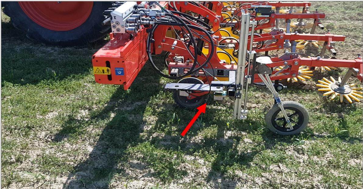
Abbildung 71: Sensoren auf unbearbeiteten Boden beim Maishacken
