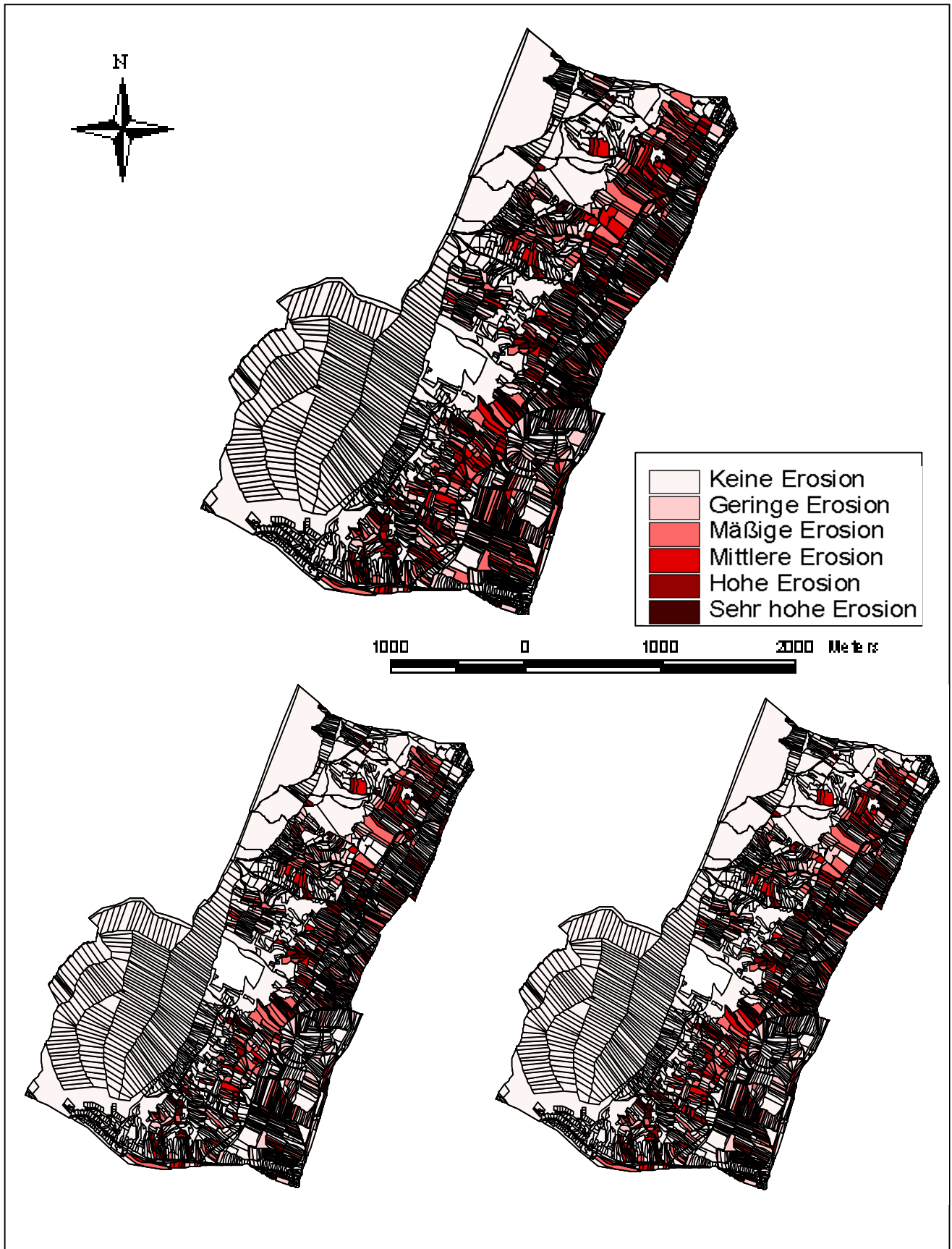
Abb. 5.7: Gegenüberstellung der Erosionsraten des Teilgebietes in der Thermenlinie bei konventioneller Anbaumethode ohne Schutzmaßnahme (Szenario 1 - oben), Situation 2002 – Reduktion durch Mulch (Szenario 2 - unten links) und Situation 2002 – Reduktion durch Untersaat (Szenario 2 - unten rechts)
