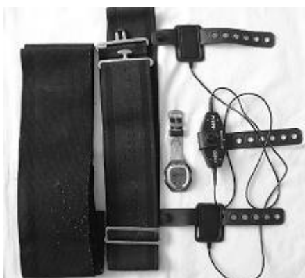
Abb. 37: Herzfrequenzmeßgeräte. In der linken Abbildung von links nach rechts: Ein elastischer Übergurt, ein Pferddeckengurt, ein Monitor (Uhr) vom Modell S810, und ein Horse Trainer Transmitter (Sender) mit Elektroden. In der rechten Abbildung eine Kuh mit angelegtem Pferddeckengurt und Transmitter.
