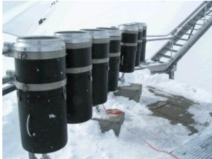
Abbildung 9.1.3-1: Bei MONARPOP verwendete Depositionssammler für den Einsatz unter hochalpinen Bedingungen
