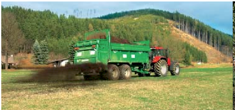
Ein Spezialkompoststreuer bringt den feinen Kompost in Mengen von 10 bis max. 20 t/ha gleichmäßig auf den Ackerboden bzw. auf die Grünlandnarbe auf.
