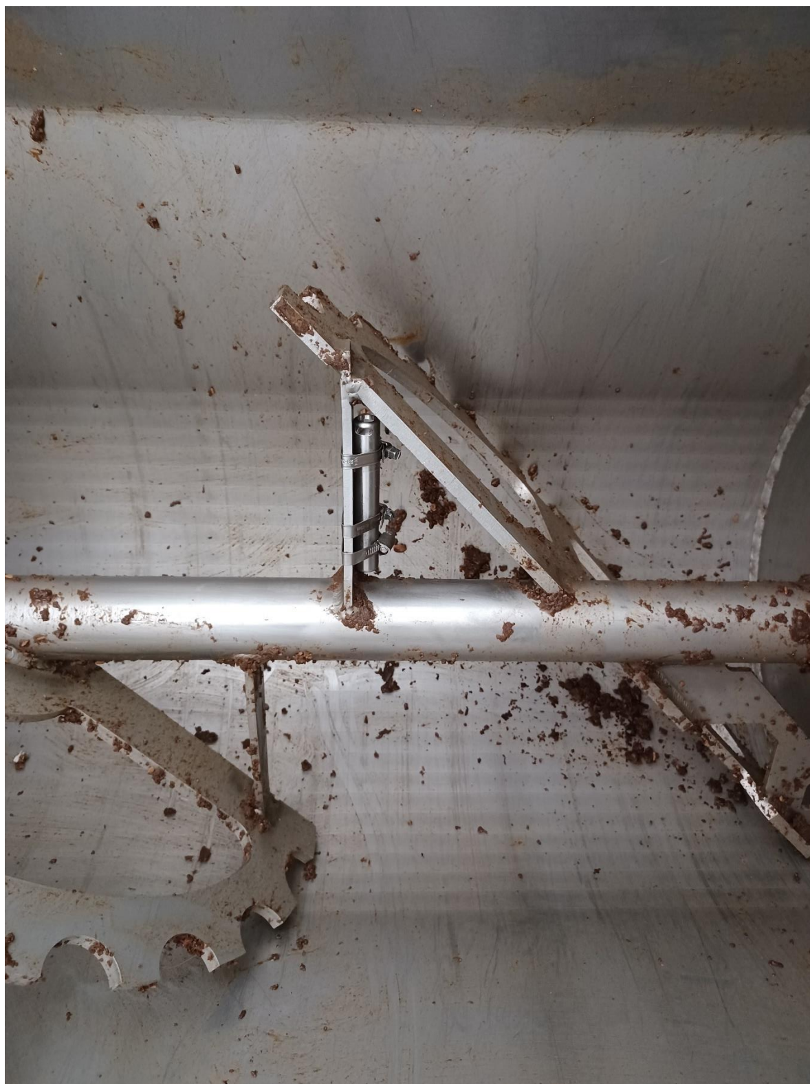
Abbildung 3 VRS Jumbo – Messer in der Prozesskammer (Quelle: Kaiblinger & Stumpf, 2023)
