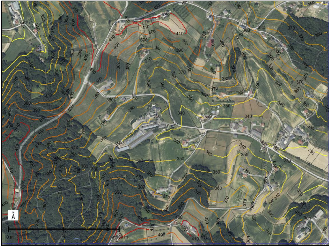
Abbildungen 7: Höhengichtlinien Beurteilungsgebiet und 3D-Modell des Geländereiefs
