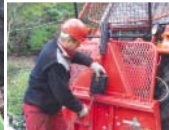
◀ Durch die Verwendung eines Druckspeichers lässt sich die Bremse auch bei ausgeschalteter Zapfwelle öffnen.
