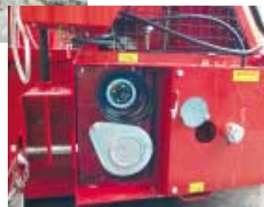
Der zweite Zapfwellenstummel ist gut geschützt und einfach durch Verschieben der Abdeckung freigegeben.
