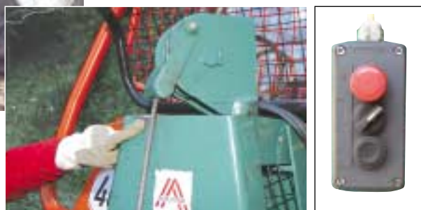
Beim Zuzug über die untere Umlenkrolle kommt es zu Scheuerungen am Wickelturm. Die Bedienflasche ist bei kalter Witterung bruchanfällig.
