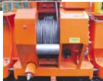
◀ Eine zusätzliche Seildruckwalze presst das Seil auf die Trommel und unterstützt das Wickelverhalten positiv.
