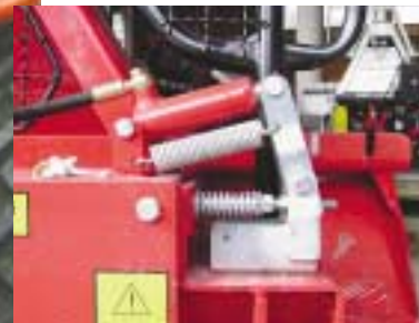
Bremszylinder und Bremsgestänge sind zwar außenliegend, die Einstellschraube für das Bremsband ist dafür leicht zugänglich.
