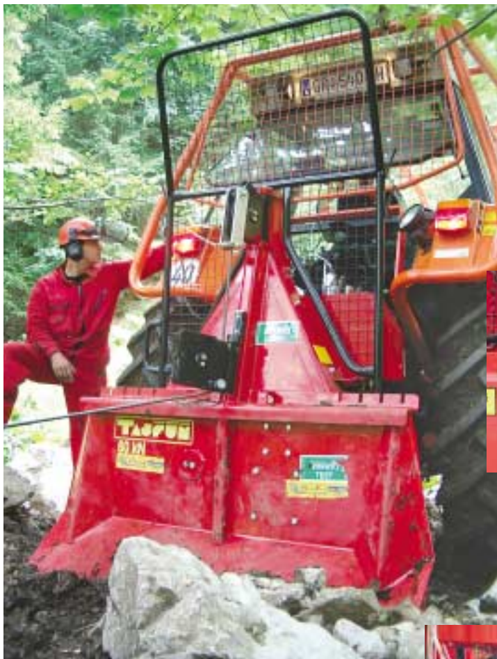
Bremszylinder und Bremsgestänge sind zwar außenliegend, die Einstellschraube für das Bremsband ist dafür leicht zugänglich.
