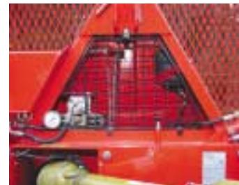
◀ Durch die Verwendung eines Druckspeichers lässt sich die Bremse auch bei ausgeschalteter Zapfwelle öffnen.
