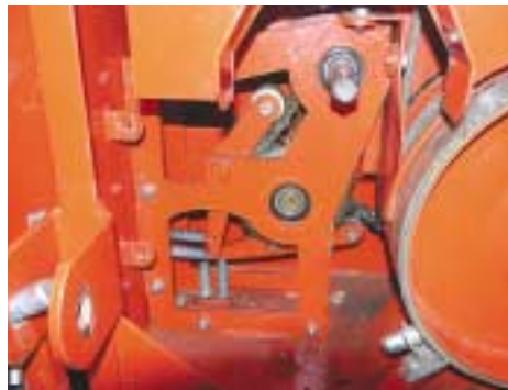
Untersetzungsgetriebe geben in der Windenkonstruktion mehr Möglichkeiten in der inneren räumlichen Verteilung der Elemente.
