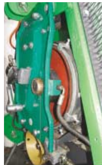
Die Verwendung eines Ringzylinders für die Kupplungs- betätigung entspricht dem Konzept einer hydraulischen Winde.
