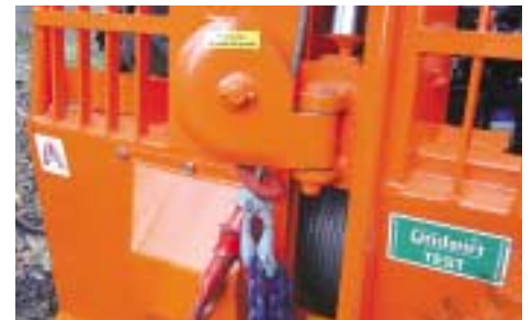
Hydraulisch verstellbare Seileinlaufrollen vereinfachen das Arbeiten.
