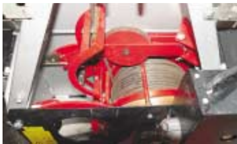
Trommelnachlauf-Stoppereinrichtungen sind über Seilablenkung und Federkraft aktiv, welche beim Seilziehen überwunden wird.
