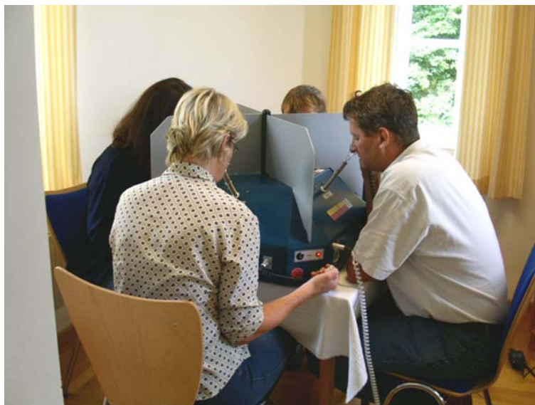
Foto 2: Bewertung von Geruchsproben am Olfaktometer TO8
