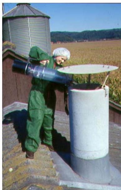
Foto 1: Probenahme über Dach mittels Unterdruck-Probenahmegerät
