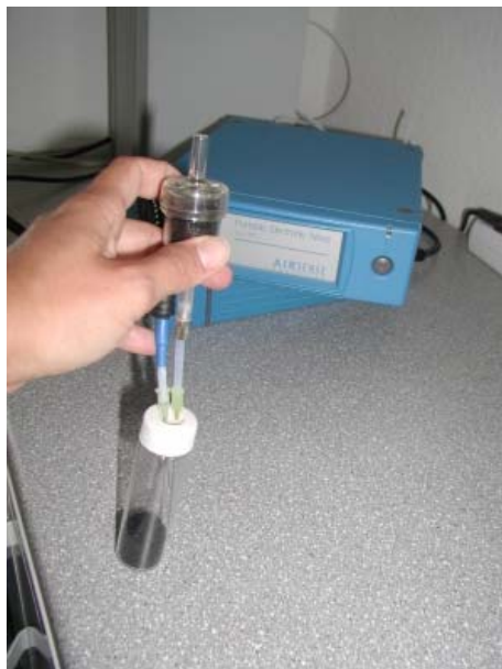
Foto 3: Durchführung einer Messung mit der elektron. Nase PEN2
