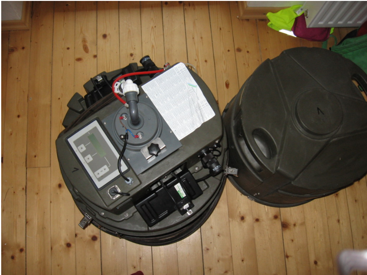
Abbildung 8: Probensammler 1. Ebene, technische Ausrüstung: Display, 2 Batterien, Ansaugpumpe, diverse Elektronik
