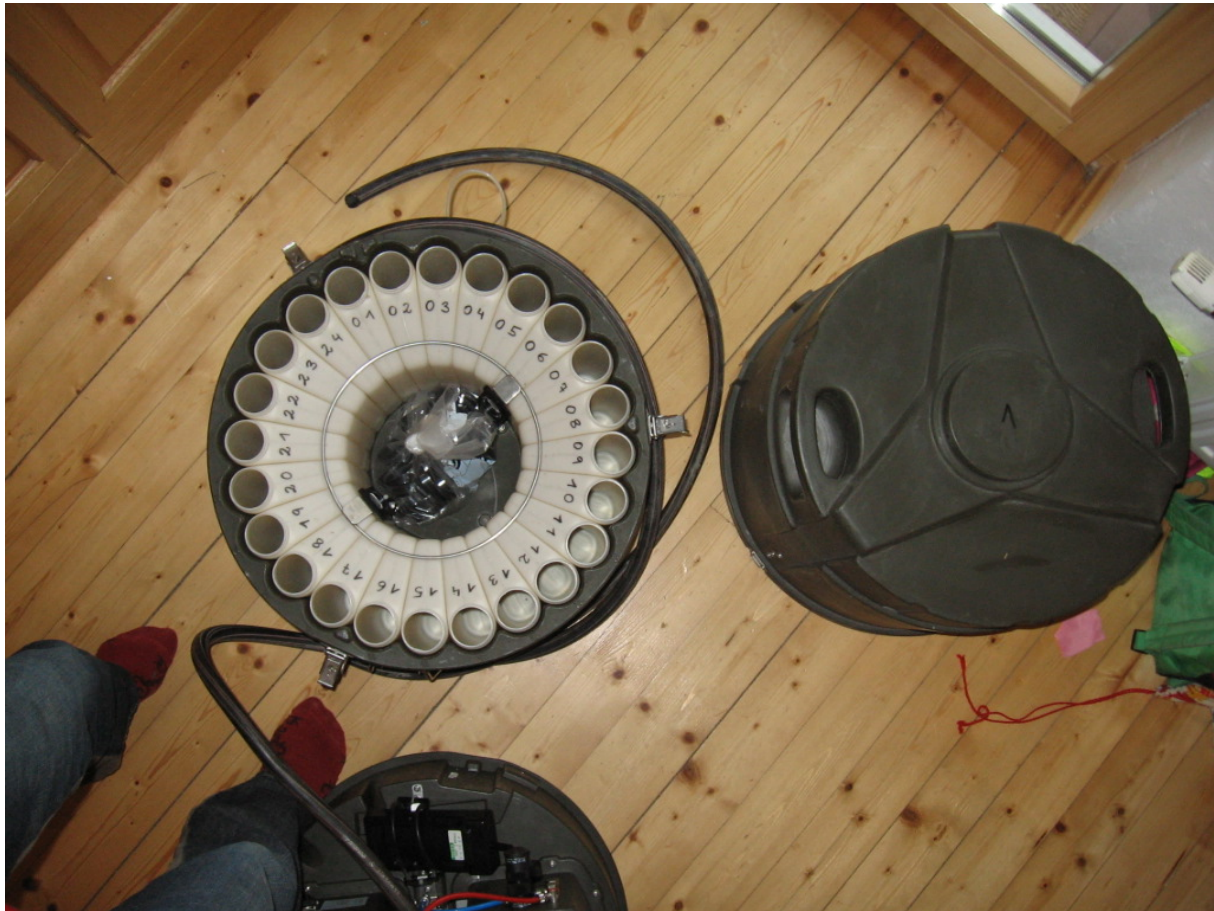
Abbildung 9: Probensammler 2. Ebene, 24 Abfüllflaschen im Rondell
