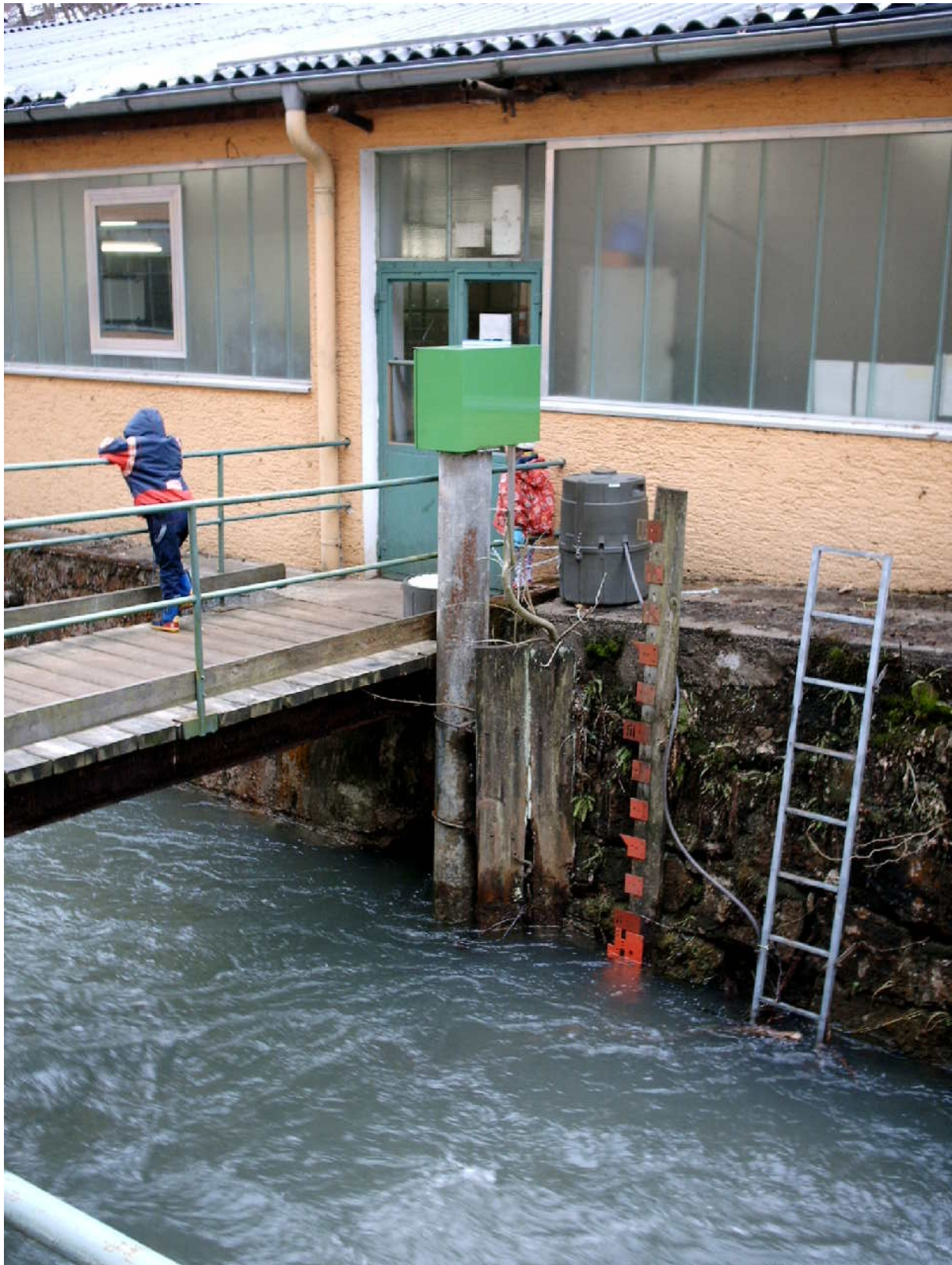
Abbildung 7: Probensammler an der Zellerache beim Messpegel
