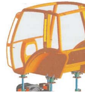
Abb. 5.1: Niveauregelungszyylinder mit Kabinenbefestigung
