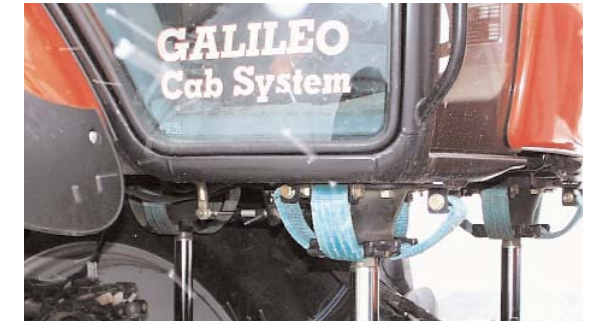
Abb. 5.1: Niveauregelungszyylinder mit Kabinenbefestigung
