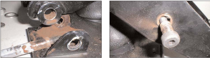
Abb. 4.11: Rost in den Lagerstellen verschlechtert den Federungskomfort
