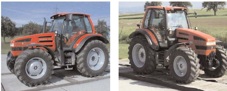
Abb. 4.4: 24m-„Testop-Bahn“ und die 35m-Holperbahn
