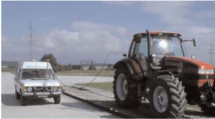
Abb. 4.3: Fahrt über die 100m-Holperbahn mit dem Messwagen zur Datenübertragung
