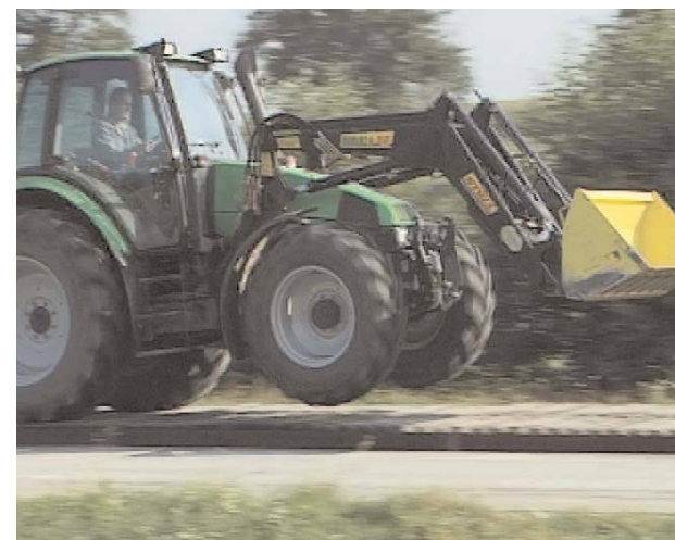
Abb. 4.41: 100 m Holperbahn ohne Vorderachsfederung (Vorderräder verlieren den Bodenkontakt)
