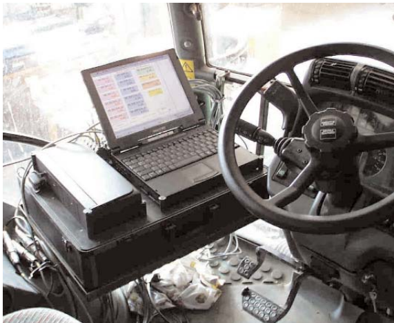
Abb. 4.2: Messdatenerfassung in der Kabine
