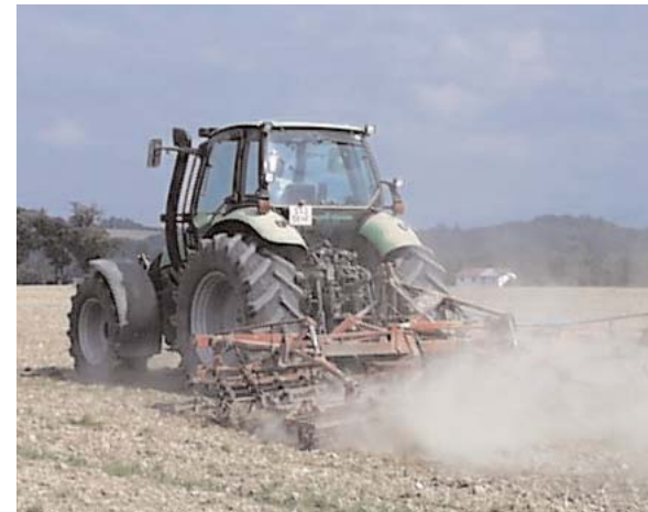
Abb. 4.16: Standardtraktor 110 kW (Versuchstraktor) mit Vorderachsfede- rung, Kabinenfede- rung und Sitzfederung
