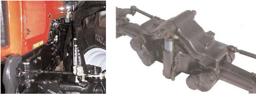
Abb. 3.30: Vier-Lenker-Mechanismus mit zentralem Federungszyylinder „Quadlink“ (Fa. Massey Ferguson)
