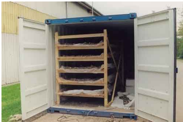
Abbildung 3-25: 20' Lagercontainer zur Probentrocknung. Links oben: Aufstellung der Container beim Versuch in Oberpullendorf, im Vordergrund ablaufendes Kondenswasser der Entfeuchtungsgeräte; unten links und rechts: Ansicht der eingebauten Stellagen
