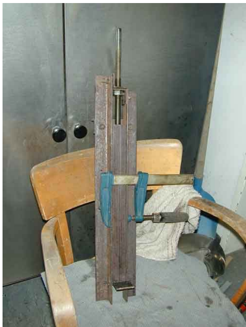
Abbildung 3-34 a und b: Probenpresse; Innere Struktur eines gepressten Blocks einer Kunststofffraktion (Schnittfläche)
