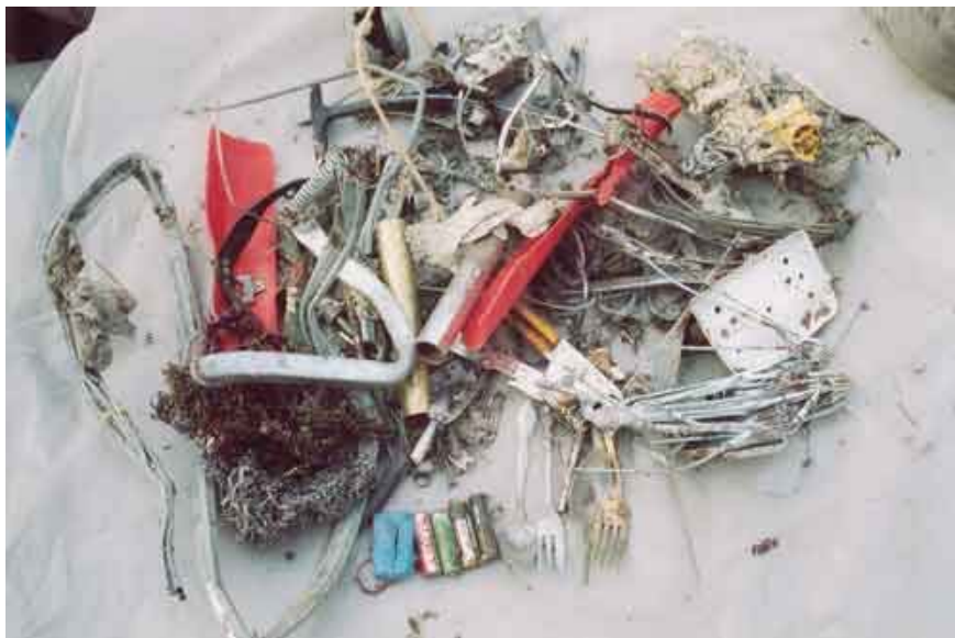
Abbildung 3-32: Aussortiertes „Konzentrat“ aus einer Fe-Schrotprobe. In dieser Fraktion sind alle Gegenstände gesammelt, die andere Schwermetalle außer Fe in hoch konzentrierter Form enthalten.
