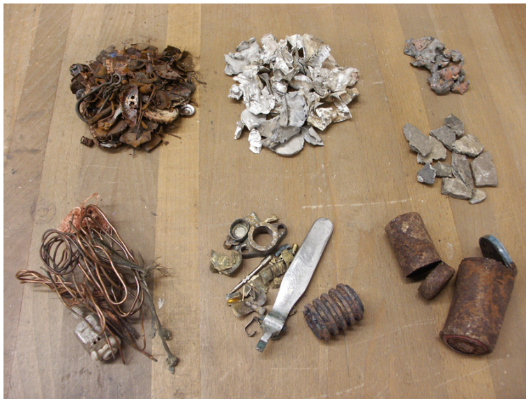
Abbildung 3-35: Aussortiertes, zerlegtes und gereinigtes Material aus einer Probe der Schwerfraktion des BASEP der MBA Oberpullendorf. Von links oben im Uhrzeigersinn: Eisen, Aluminium, Blei, Eternit, Batterien, Messing (zum Teil verchromt), Kupfer (aus Kabeln, Wicklungen)
