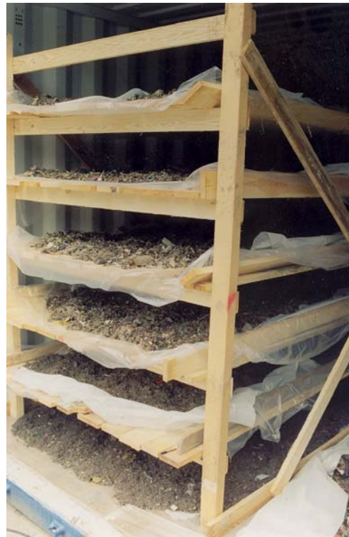
Abbildung 3-25: 20' Lagercontainer zur Probentrocknung. Links oben: Aufstellung der Container beim Versuch in Oberpullendorf, im Vordergrund ablaufendes Kondenswasser der Entfeuchtungsgeräte; unten links und rechts: Ansicht der eingebauten Stellagen
