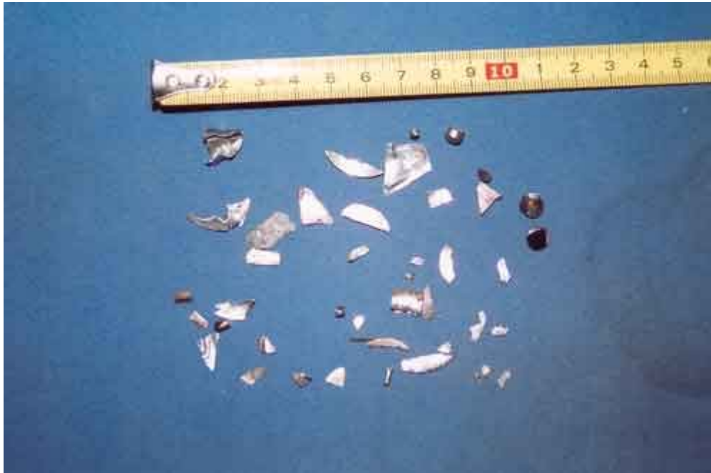
Abbildung 3-39: Durch „spezifisches“ Verjüngen gewonnene Teilprobe der massiven Stücke aus einem „Konzentrat“ einer Fe-Schrottprobe aus der MBA Oberpullendorf
