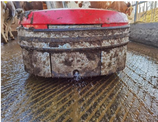
Abbildung 6: Die Bewässerung vor und nach der Reinigung kann mithilfe den Reinigungserfolg zu verbessern.
