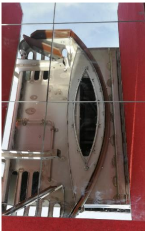
Abbildung 8: Spiegelansicht des Saugroboters von unten – gut sichtbar sind die Räumklappen und der Saugschlitz.
