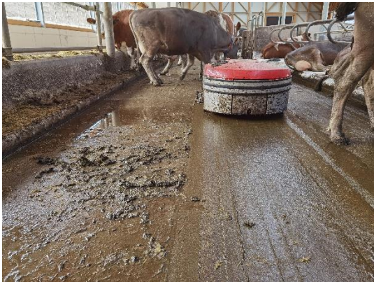
Abbildung 1: Der Lely Collector saugt die Gülle vom Boden ab. Die Routen können je nach Verschmutzungsgrad frei programmiert werden, auch Zwischengänge und Ausläufe werden mitgereinigt.
