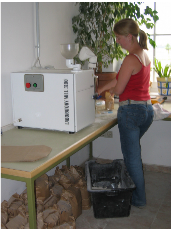
Foto 7: Qualitätsanalyse: Vorbereitungen für die Fallzahlbestimmung
