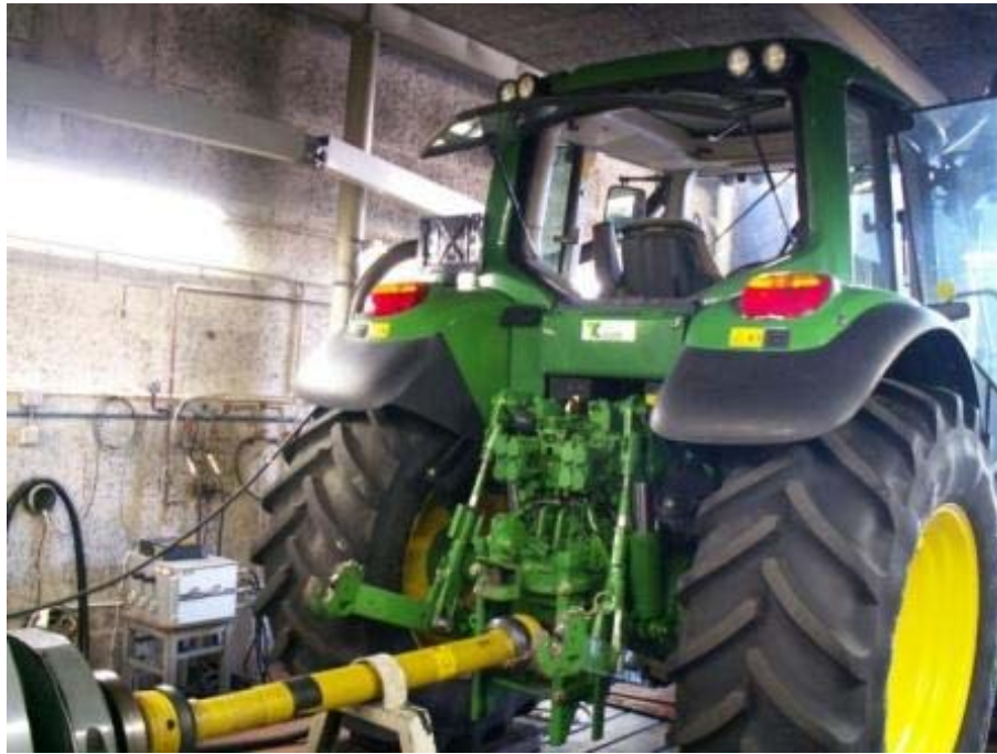
Abbildung 49: Leistungsmessung an der Zapfwelle am Motorprüfstand von FJ-BLT
