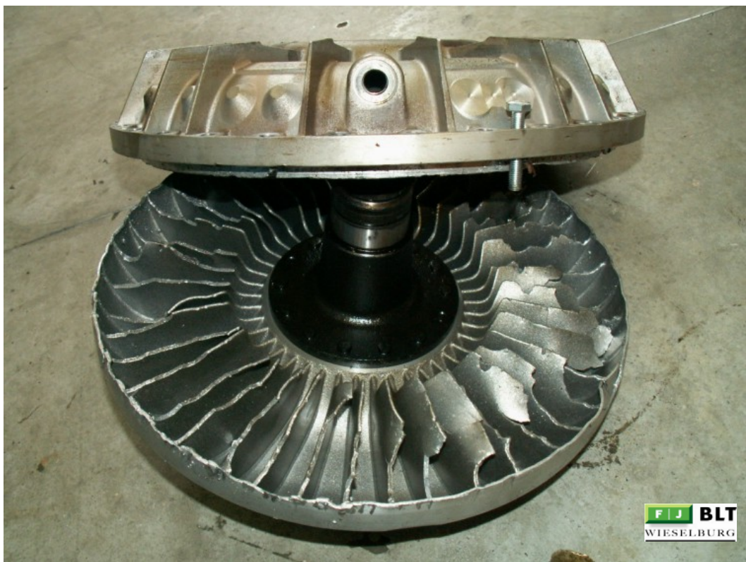
Abbildung 26: 29-NÖ Schaden an der Turbokupplung
